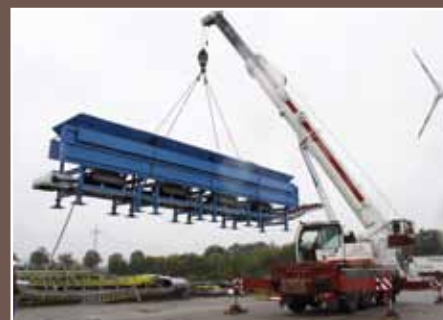
DIE SEMIMOBILE Dosi für ortsgebundene Einsatzfälle lässt sich rasch mit einem Mobilkran aufstellen. Fotos: FAF
