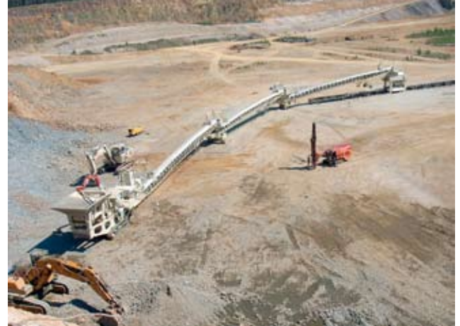
10 Link-Förderbänder zum Materialtransport (Metso Minerals) Link-conveyor belts for materials handling (Metso Minerals)
