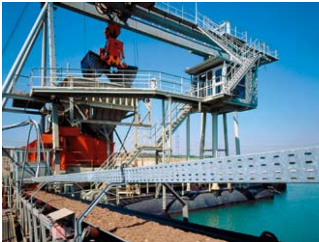
15 Schwimmgreifer bei Cemex (Cemex Deutschland) Floating excavator with grab at Cemex (Cemex Germany)
