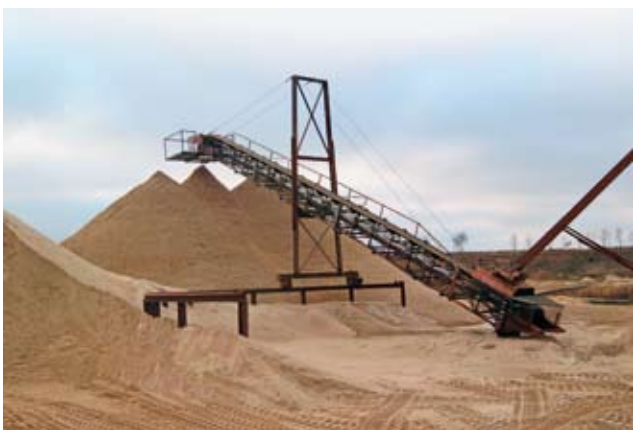
19 Konventionelles Haldenband (H. Dallmann GmbH, Harder) Conventional stockpiling belt conveyor (H. Dallmann GmbH, Harder)
