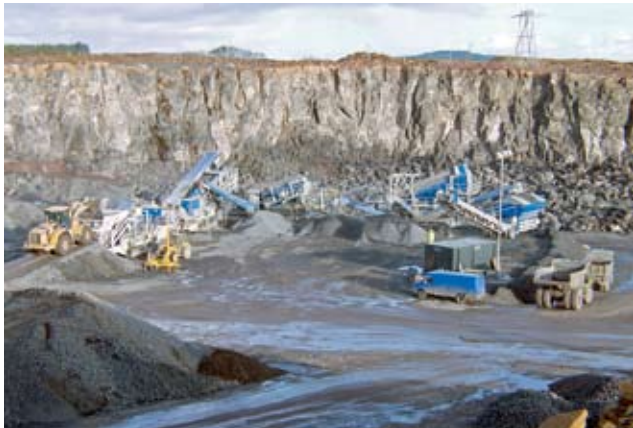
13 Mobilgeräte-Kombination – 2 Brech-, 3 Siebstufen (Kleemann) Mobile equipment combination – 2 crushing and 3 screening stages (Kleemann)
